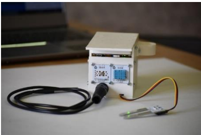
Рисунок 1. Общий вид мини-метеостанции (исполнение ММС v.3 с внешними датчиками влажности почвы и температуры)
